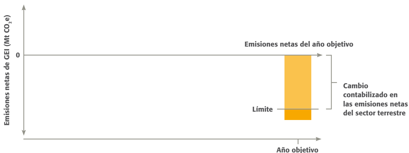
Figura 6.6 Contabilización sin hacer referencia a un año/periodo base o emisiones del escenario de referencia utilizando un límite
